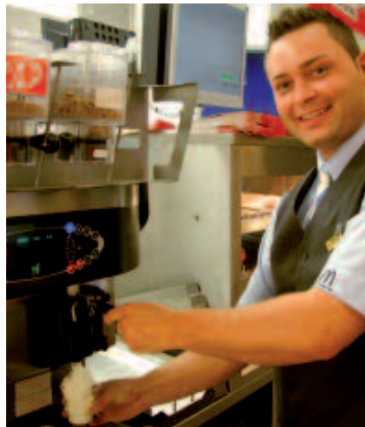
Die Eismaschine kühlt das Grundprodukt und führt ihm Luft zu – heraus kommt Eis oder Milchshake.
