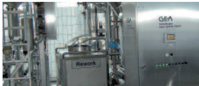
Das Herzstück der Molkerei: Hier werden die Zutaten des Produkts gemischt, erhitzt und homogenisiert.
